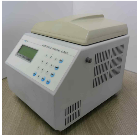
(1998) MyGenie™32 Thermal block 반도체 Peltier 방식 적용 PCR 장비
